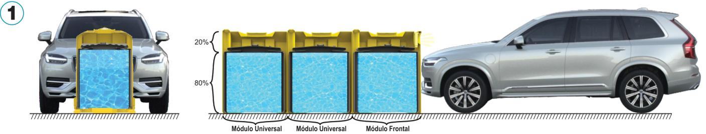
El ensamble de los contenedores flexibles interiores de cada módulo, se llena con agua hasta el 80% de la capacidad del contenedor exterior, se extrae el aire que queda en el ensamble de los contenedores flexibles interiores, se cierran herméticamente mediante una tapa con válvula de alivio de presión y se pliega el ensamble al interior del contenedor exterior.
