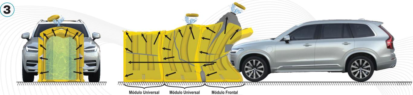
Si la presión ejercida durante el impacto es muy alta, se abre la válvula de alivio de presión y deja salir el agua de manera controlada, de este modo se libera parte de la presión ejercida sobre el agua y se alarga el tiempo de contacto entre el vehículo y el sistema de triple contenedor.
