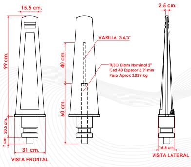
• Marcar la ubicación de los barrenos, haga una perforación de diámetro 8" x 11" de profundidad con la ayuda de un sacabocados, para insertar la base del bolardo.
